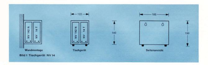
Für große Empfangsanlagen eignet sich die Gestellausführung NV 14 II, bei der bis zu 8 Trennverstärkerkassetten NV 14 T von dem Adapter NV 142 E aufgenommen und mit Strom versorgt werden (siehe auch Bild 2).
